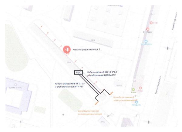
Шлагбаум автоматический, откатной с электромеханическим приводом NICE RB 400
